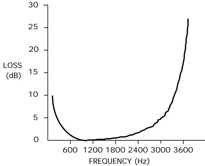
**ATTENUATION DISTORTION VERSUS FREQUENCY
